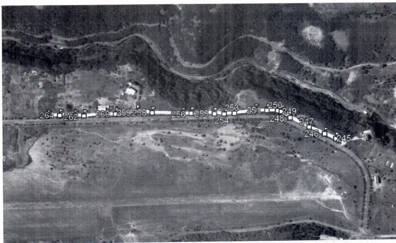
Рисунок 1 – Ситуационный план-схема подземного газопровода среднего давления ГРС города Джермук – Левый берег Вайоц Дзорского марза
